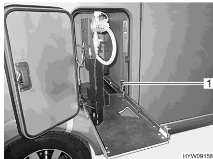
Bilde 91 Gasskaputtrekk i posisjon for utskifting
