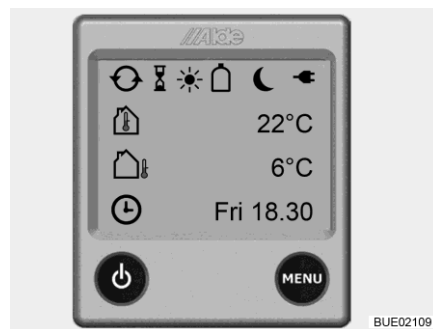
Bilde 123 Startbilde (kontrollpanel)
