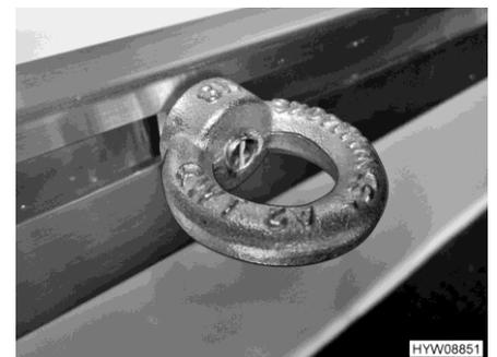
Fig. 7 Œillet de serrage (bloqué)
