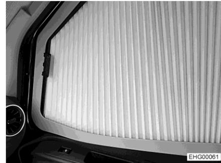
Fig. 46 Dispositif occultant plissé (fenêtre côté passager)
