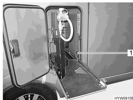
Fig. 91 Extension du compartiment à gaz en position de changement de bouteille
