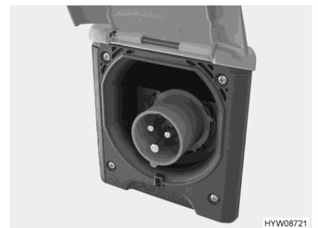
Fig. 107 Raccordement 230 V sur le véhicule (prise de courant CEE)
