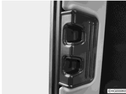
Fig. 45 Poignée de verrouillage (fenêtre côté passager)
