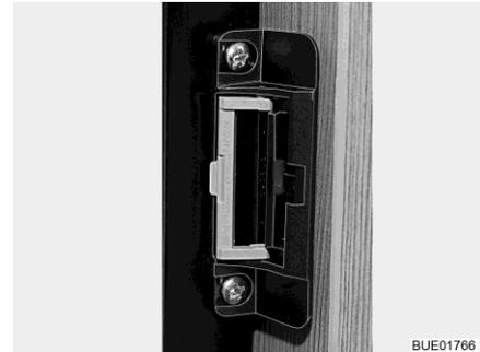
Fig. 152 Dispositif de fermeture (position de ventilation)
