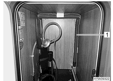
Fig. 160 Tuyau d'évacuation des eaux usées (extension du compartiment à gaz)
