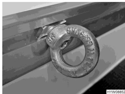
Fig. 6 Œillet de serrage (déplaçable)
