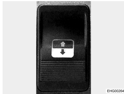
Kuva 19 Kytkin (kuljettajan ovenssa oleva sähkökäyttöinen ikkunannostin)
