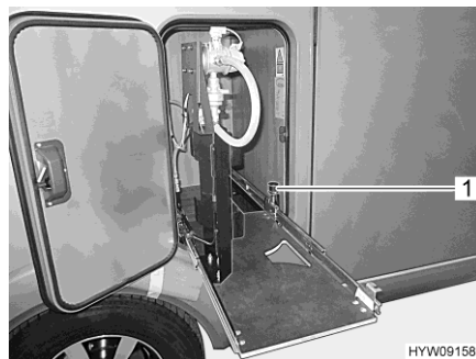
Kuva 93 Kaasupullokotelon alusta vaihtoasennossa
