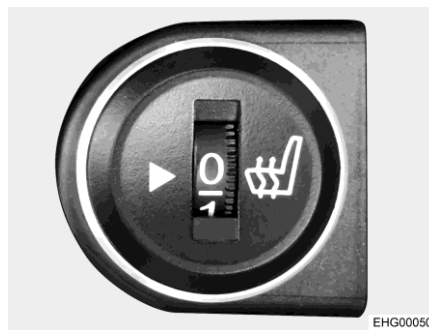
Obr. 18 Spínač vyhřívání sedadla
