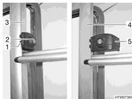
Obr. 4 Zajištění (zadní žebřík)
