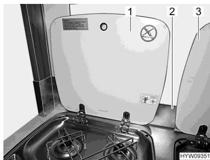
Obr. 125 Ochranný plech proti plamenům (vaříč)
