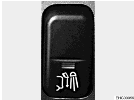
Obr. 30 Kolébkový spínač (osvětlení zadního prostoru)
