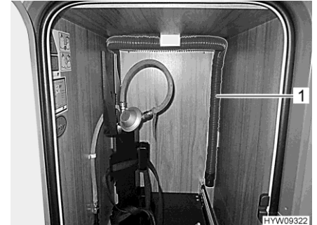
Obr. 143 Hadice odpadní vody (zá- suvka plynové skříně)
