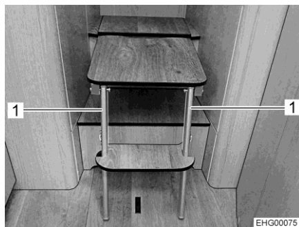
Obr. 85 Výstupní žebřík (vyklopený)
