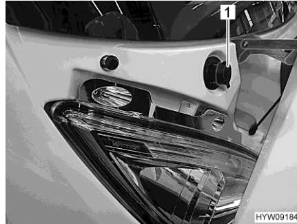
Obr. 25 Plnicí hrdlo (nádržka ostřikovače)
