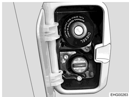
Obr. 26 Plnicí hrdlo palivové nádrže
