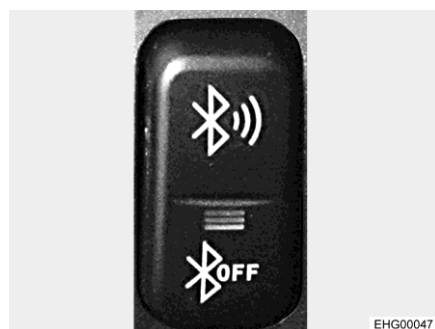
Obr. 98 Kolébkový spínač (připojení Bluetooth)
