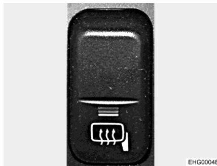
Obr. 21 Spínač (vyhřívání zrcátka)
