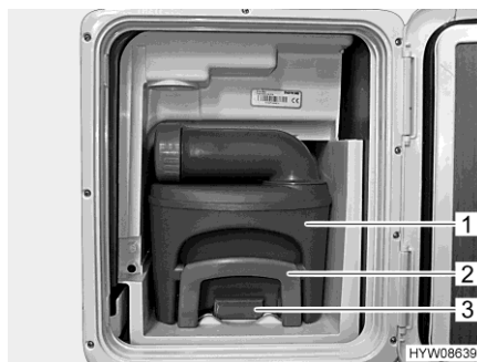
Obr. 149 Nádrž na fekálie (ve vozidle)
