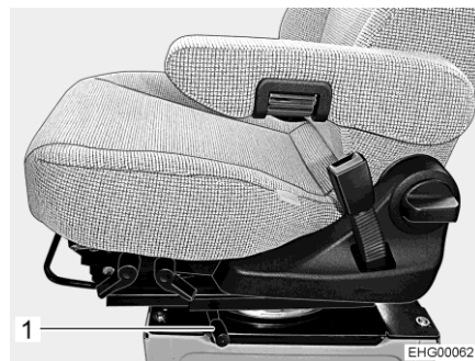
Obr. 58 Páka (otáčení sedadla) (Aguti GIS-Liner)
