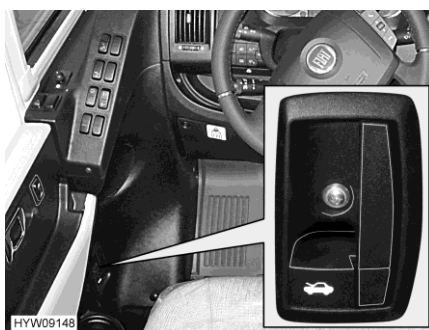
Obr. 23 Odjišťovací páka (kapoty motoru)
