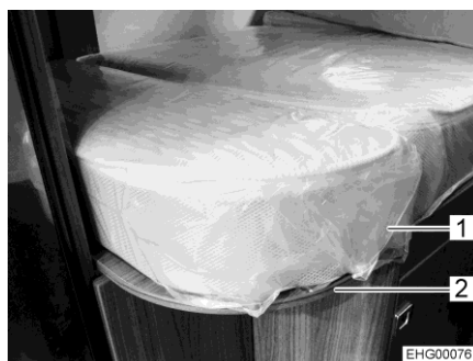
Obr. 80 Prodloužení ložné plochy s přídavným čalouněním
