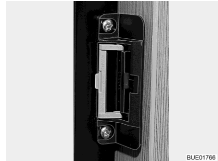
Obr. 136 Uzavírací zařízení (větrací poloha)
