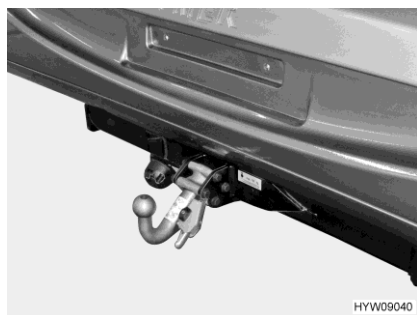
Obr. 8 Tažné zařízení (odnímatelné)
