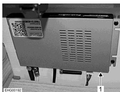
Obr. 110 Řídicí jednotka (TV satelitní systém, ten Haaft)
