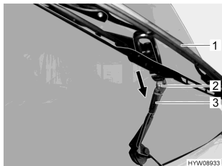
Obr. 157 Výměna lišty stěrače
