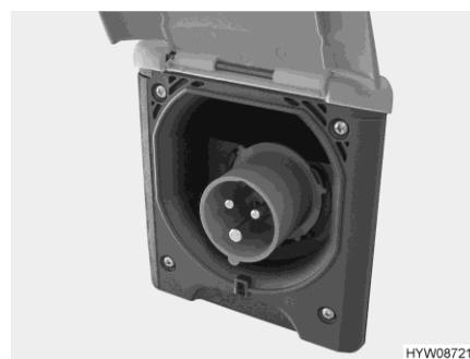
Obr. 107 Přípojka 230 V na vozidle (zásuvka CEE)
