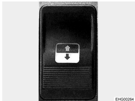
Obr. 19 Spínač (elektrický spouštěč okna ve dveřích řidiče)
