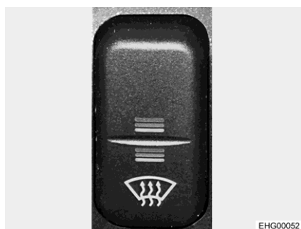
Obr. 11 Kolébkový spínač (vyhřívání čelního skla)
