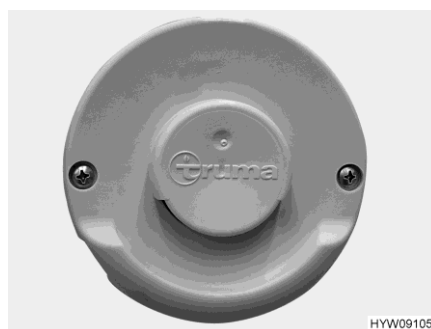
Obr. 119 Nástěnný komín (teplo-vzdušné topení)
