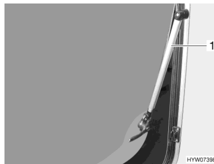
Obr. 45 Vyklápěcí okno s automatickým vyklápěcím mechanismem
