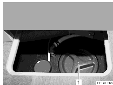
Obr. 155 Nádrž na odpadní vodu
