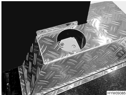
Bilde 212 Elektrisk spillvannsventil (bakre lasteluke)
