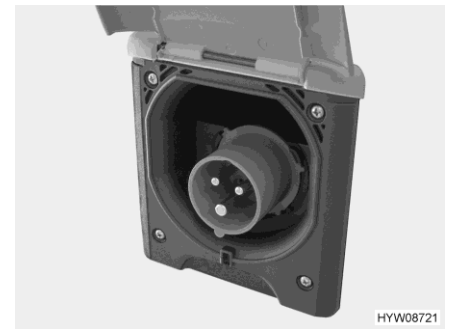
Bilde 153 230 V-tilkobling til kjøretøyet (CEE-stikkontakt)
