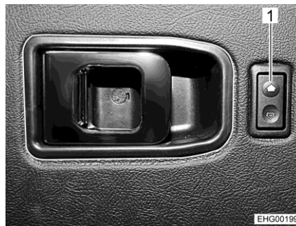
Bilde 31 Bryter (elektrisk vindusheis på i førerdøren)
