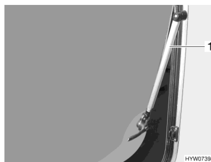
Bilde 62 Vindu som kan åpnes utover med armer med automatisk låsing
