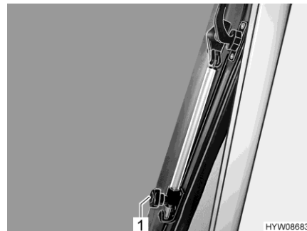
Bilde 65 Dreiearm (taklukevindu)
