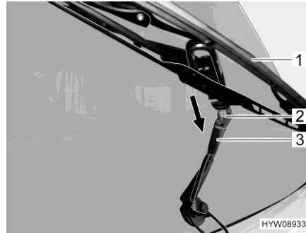
Bilde 231 Skifte vindusviskerblad
