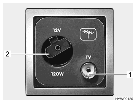
Fig. 59 Prese (antenna satellitare esterna)
