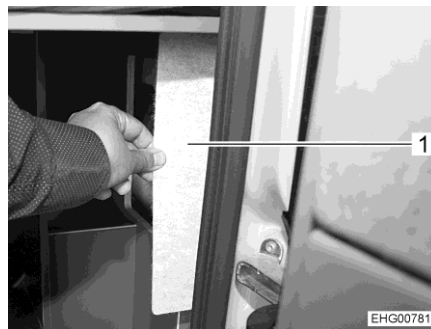
Bild 145 Zugang zu Rückleuchten (Fiat)
