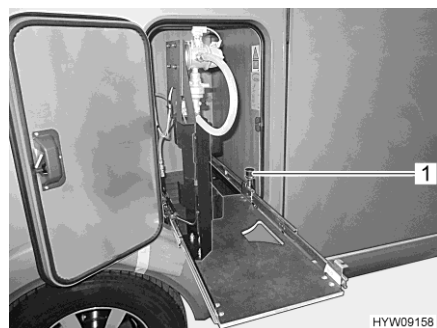
Bilde 82 Gasskaputtrekk i posisjon for utskifting
