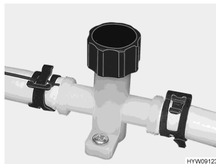
Bilde 113 Tappekran (vannledning)
