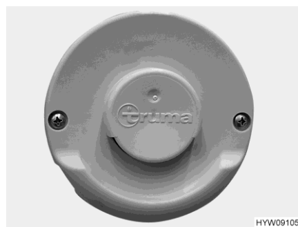
Bilde 114 Veggpipe (varmlufts-varmeanlegg)
