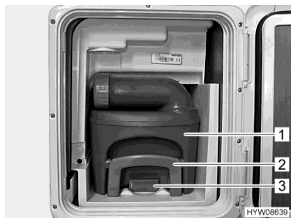
Bild 141 Latrintank (i fordonet)
