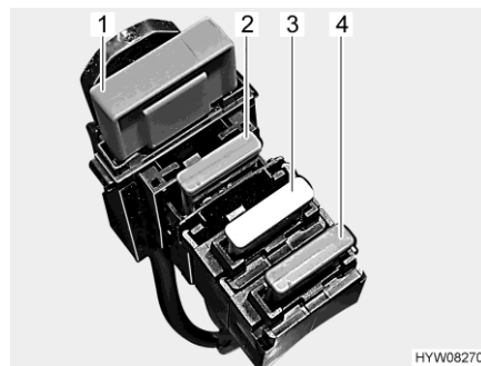
Fig. 100 Fusibles (batterie de cellule)
