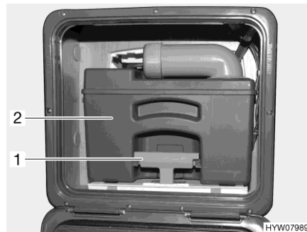
Fig. 143 Réservoir pour matières fécales (dans le véhicule) (alternative)
