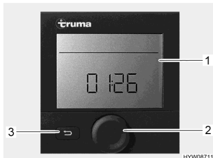
Fig. 109 Unité de commande (chauffage à air chaud et chauffe-eau)
