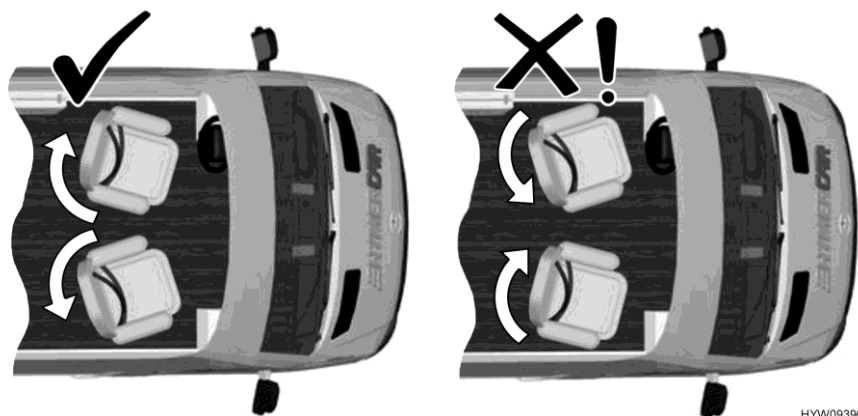
Fig. 49 Tenir compte du sens de rotation des sièges conducteur et passager
