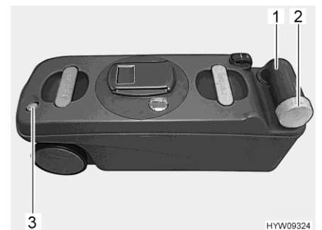
Fig. 142 Réservoir pour matières fécales
