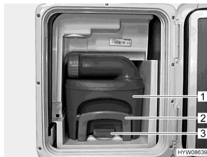
Fig. 141 Réservoir pour matières fécales (dans le véhicule)
