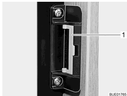
Fig. 122 Dispositif de fermeture (position normale)
