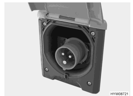
Fig. 97 Raccordement 230 V sur le véhicule (prise de courant CEE)
