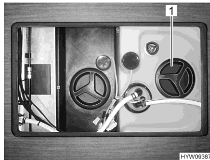
Bild 225 Rengöringsöppning (vattentank)
