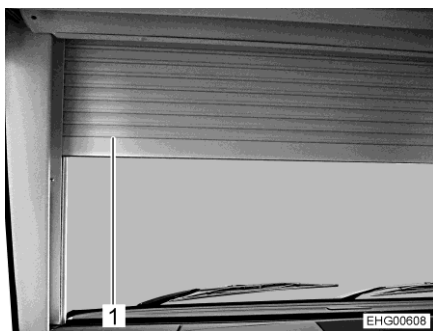
Bild 72 Mörkläggningsrullgardin används som solskydd
