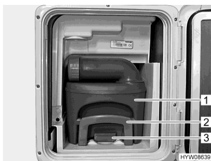
Bild 220 Latrintank (i fordonet)
