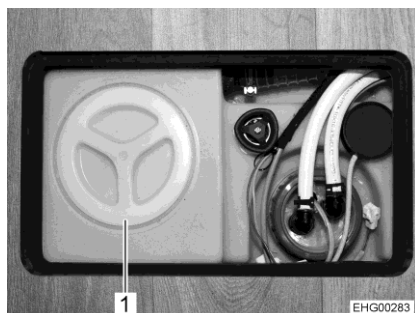
Fig. 116 Ouverture de nettoyage (réservoir d'eau)
