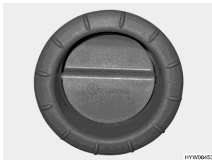
Fig. 85 Buse de sortie d'air (chauffage à air chaud)
