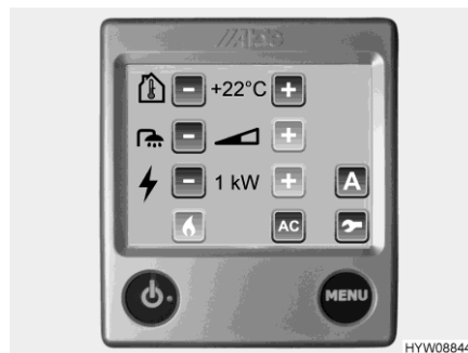
Fig. 124 Menu delle impostazioni (centralina di controllo)
