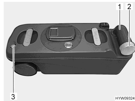
Fig. 171 Serbatoio fecale (esempio)
