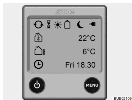
Fig. 123 Schermata iniziale (centralina di controllo)
