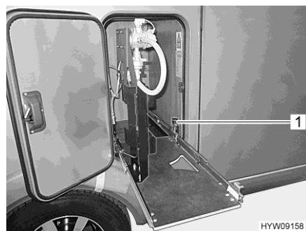
Fig. 85 Base estraibile del vano portabombole in posizione di sostituzione
