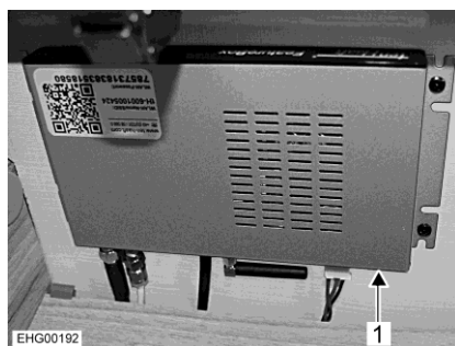
Fig. 100 Apparato di controllo (impianto satellitare TV, ten Haaft)
