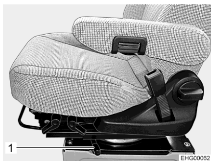
Fig. 52 Leva (rotazione del sedile) (Aguti GIS-Liner)
