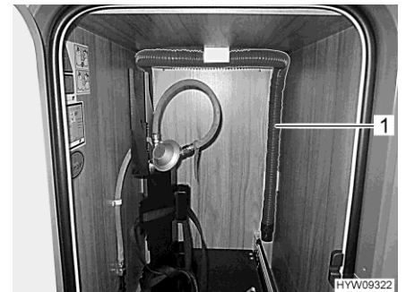
Fig. 130 Tubo di gomma per lo scarico (base estraibile del vano portabombole)
