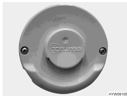
Fig. 111 Camino da parete (riscaldamento ad aria calda)
