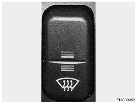
Fig. 9 Interruttore a bilico (riscaldamento del parabrezza)
