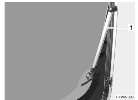
Fig. 42 Finestra apribile con deflettore automatico
