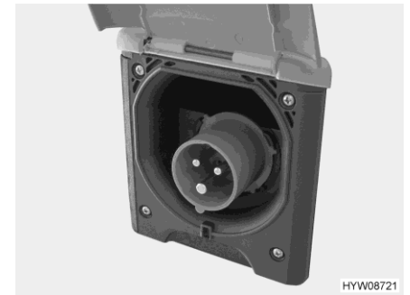
Fig. 97 Collegamento a 230 V al veicolo (presa CEE)
