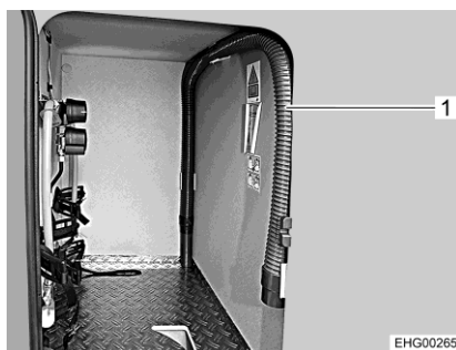
Bilde 129 Spillvannsslange (gasskap)
