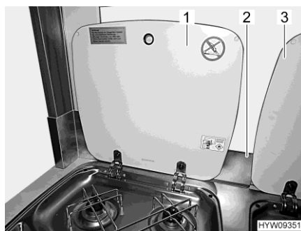
Bilde 117 Flammevernplate (kokeplassen)
