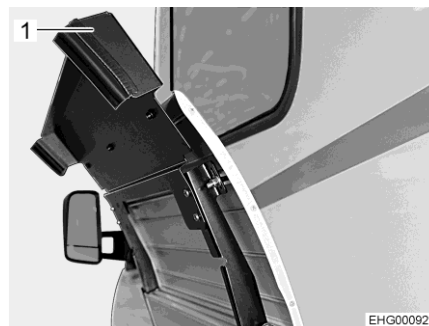
Bilde 134 Gasskap (uvendig luke åpent)
