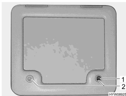
Bilde 219 Klaff (kloakktank)
