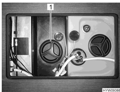
Bilde 226 Rengjøringsåpning (spillvannstank)
