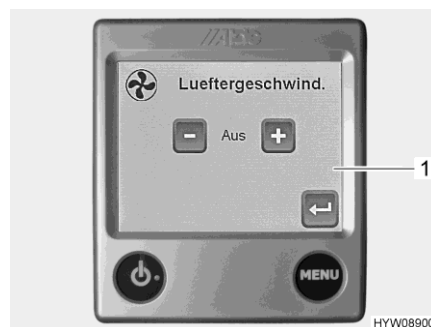
Bilde 184 Kontroll (tilleggsvifte)
