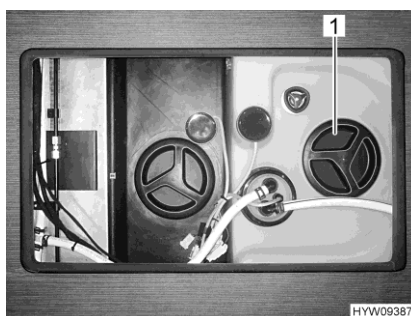
Bilde 225 Rengjøringsåpning (vanntank)
