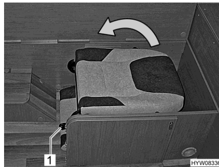
Kuva 29 Lisäistuimen taittaminen auki 1
