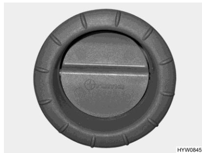
Bilde 118 Luftdyse (varmlufts-varmeanlegget)
