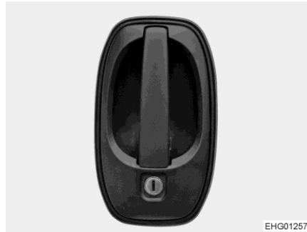
Bilde 36 Dørlås (førerdør/boenhetsdør utvendig)
