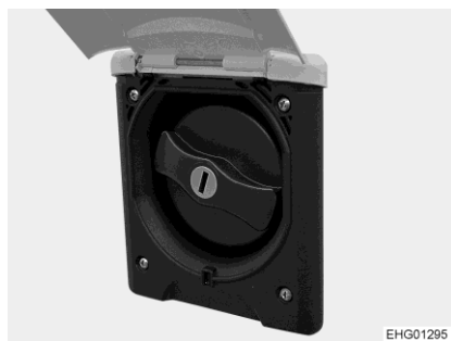
Bilde 144 Deksel (drikkevann-påfyllingsstuss)
