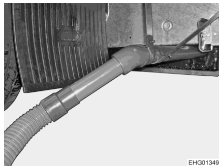
Bilde 148 Avløpsrør med spillvannsslange
