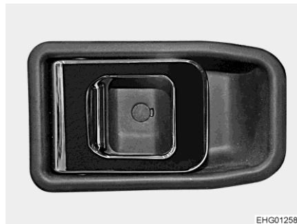
Bilde 37 Dørlås (førerdør/boenhetsdør innvendig)
