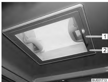
Bild 24 Taklucka med snäpplås
