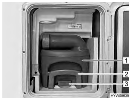
Bild 112 Latrintank (i fordonet)
