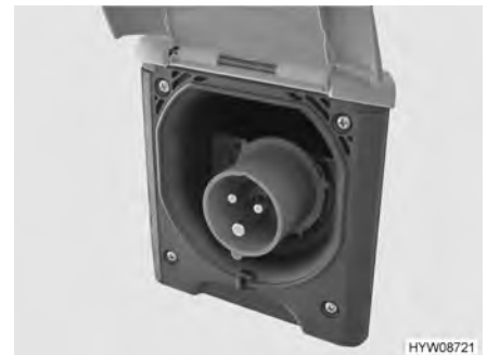
Bild 67 230 V-anslutning på fordonet (CEE-uttag)
