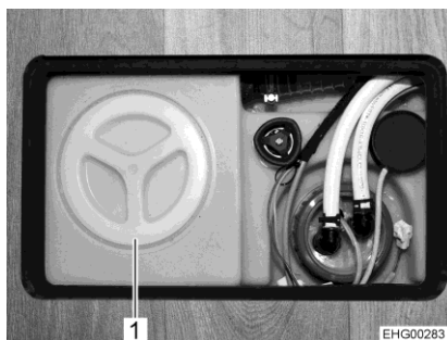
Rys. 133 Otwór do czyszczenia (zbiornik na wodę)
