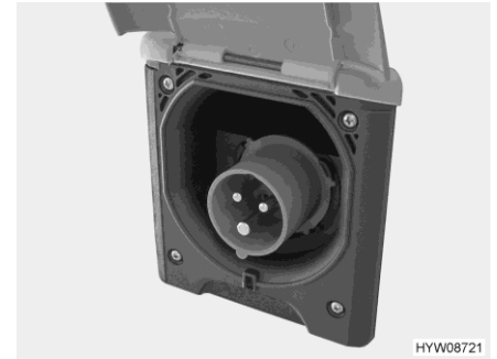
Bilde 77 230 V-tilkobling til kjøretøyet (CEE-stikkontakt)
