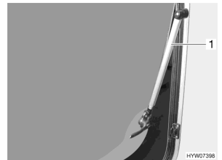
Bilde 22 Vindu som kan åpnes utover med armer med automatisk låsing
