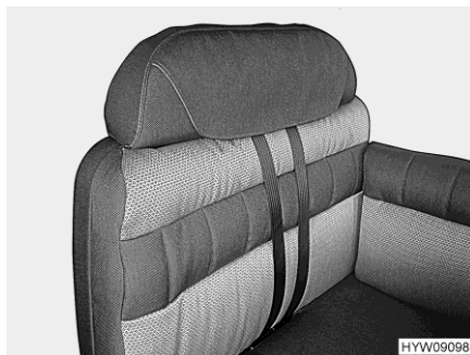
Obr. 20 Hlavová opěrka (lavice)
