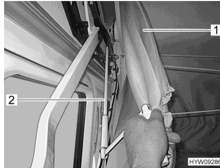
Bild 75 Handvev för nöddrift
