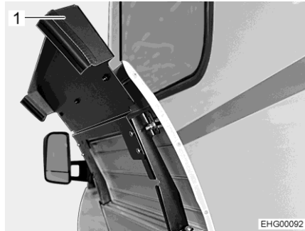
Bild 134 Gasbox (utvändig lucka öppen)
