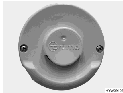
Fig. 111 Tubo de chimenea en la pared (calefacción de aire caliente)
