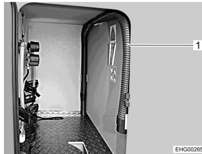
Fig. 129 Manguera de aguas residuales (caja para bombonas de gas)
