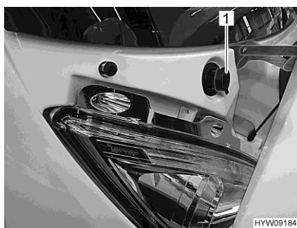
Fig. 22 Tubo de llenado (depósito de agua para lavar)
