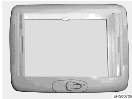
Obr. 72 Střešní poklop (zavřený)
