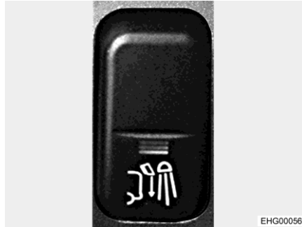
Rys. 45 Przelącznik kołyskowy (oświetlenie tyłu pojazdu)
