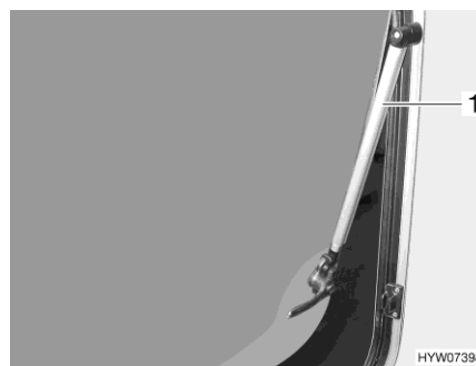
Rys. 64 Okna uchylne z automatycznymi teleskopami
