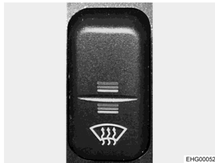
Rys. 11 Przelącznik kołyskowy (ogrzewanie przedniej szyby)
