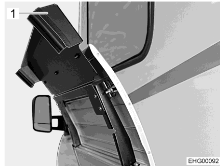
Rys. 132 Skrzynia na butle gazowe (zewnętrzna klapa otwarta)
