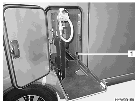
Rys. 131 Wyciągana skrzynia na butle gazowe w położeniu umożliwiającym wymianę butli
