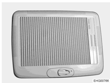
Rys. 74 Okno dachowe (plisa lamelkowa zamknięta)
