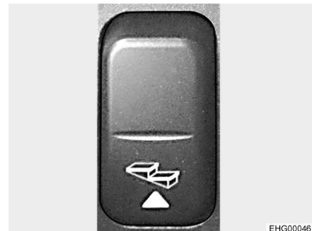
Rys. 10 Przełącznik kołyskowy stopnia do wchodzenia (listwa z przełącznikami)
