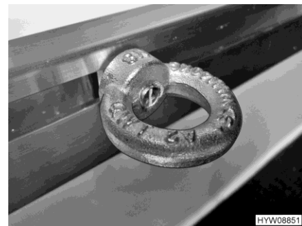
Rys. 7 Zaczep do mocowania (zaciśnięty)
