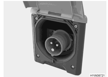
Rys. 151 Przyłącze 230 V w pojeździe (gniazdo CEE)
