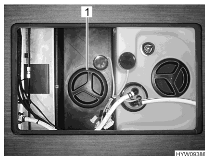
Rys. 221 Otwór do czyszczenia (zbiornik na ścieki)
