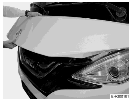
Rys. 39 Prawidłowe położenie uchwytu przy otwieraniu maski silnika
