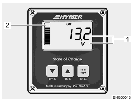
Rys. 141 Panel z wyświetlaczem (wskazywanie napięcia akumulatora)
