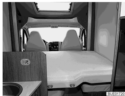
Rys. 107 Łóżko podnoszone, opuszczone całkowicie (zależnie od modelu)
