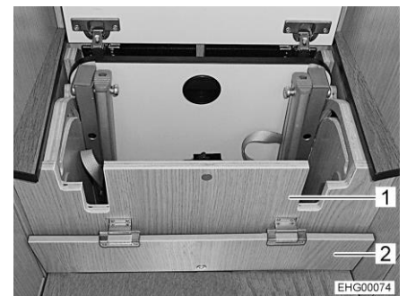
Rys. 117 Stopień do wchodzenia (otwarty)
