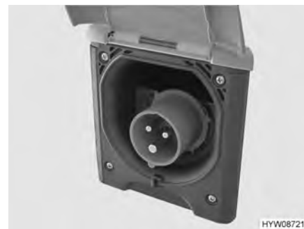
Bilde 66 230 V-tilkobling til kjøretøyet (CEE-stikkontakt)
