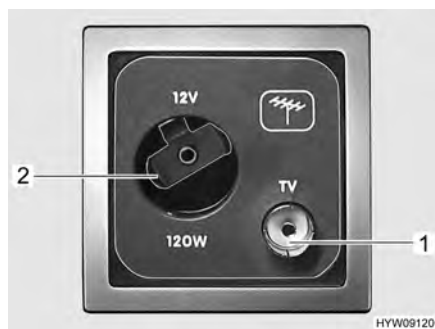
Bilde 49 Stikkontakter (ekstern satellittantenne)
