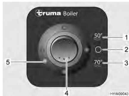
Bilde 83 Betjeningsdel for gassdrift (varmtvannsbereder Truma)
