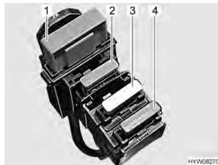
Bilde 68 Sikringer (boenhets-batteri)
