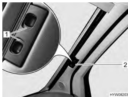
Fig. 20 Tendina oscurante pieghevole (parabrezza, Fiat)
