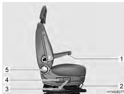
Fig. 7 Elementi di comando al sedile (esempio Fiat)
