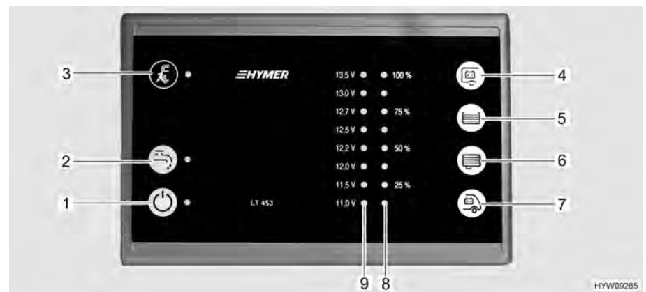
Fig. 65 Pannello di controllo (LT 453)
