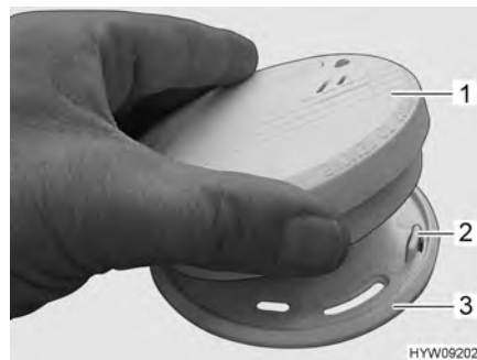
Fig. 119 Montaggio del rivelatore di fumo
