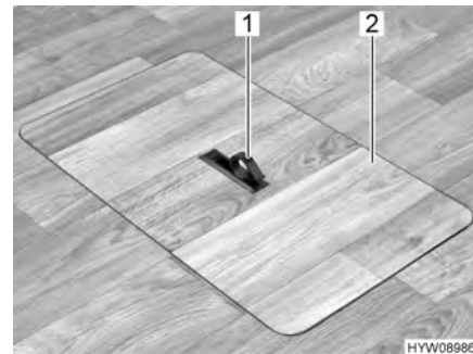
Fig. 43 Copertura vano pavimento (maniglia estratta)
