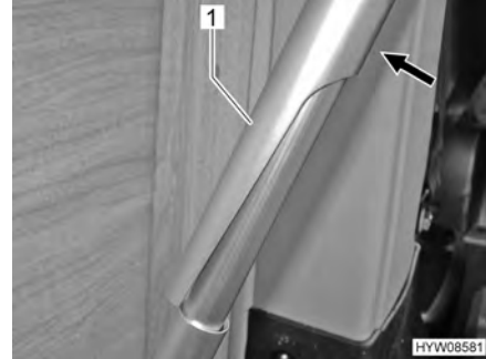
Fig. 45 Piede di sostegno (sbloccato)
