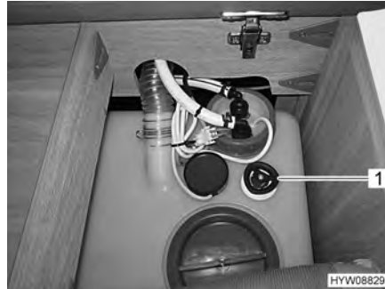
Fig. 100 Maniglia girevole (scarico acqua)
