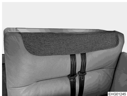
Fig. 92 Rivestimento delle cinture di sicurezza montato
