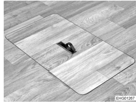
Fig. 89 Copertura per interventi di manutenzione (maniglia estratta)
