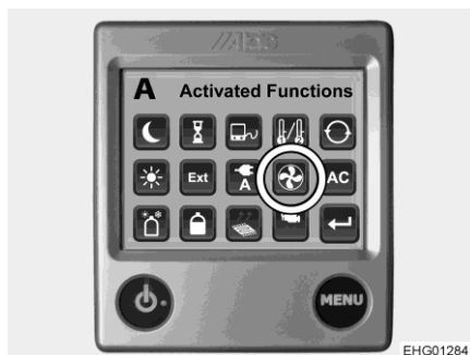
Fig. 178 Funzione booster (ventola aggiuntiva)
