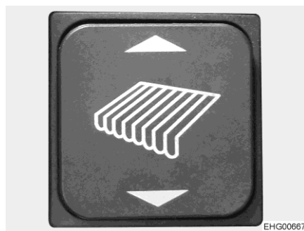
Fig. 48 Interruttore a bilico tenda (zona di ingresso)
