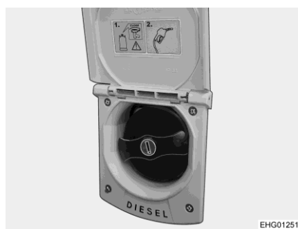
Fig. 38 Bocchettone di riempimento per il rifornimento di carburante
