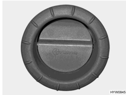
Fig. 162 Bocchetta di uscita dell'aria (riscaldamento ad aria calda)
