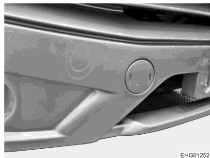
Fig. 40 Copertura (alloggiamento dell'occhiello di traino)
