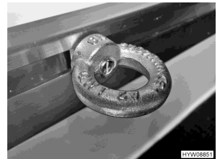
Fig. 5 Occhiello di ancoraggio (serrato)
