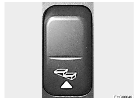
Fig. 8 Interruttore a bilico per scalino di ingresso (pannello degli interruttori)
