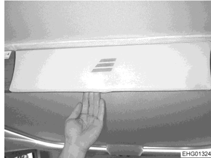
Fig. 106 Panel (pull-down bed)
