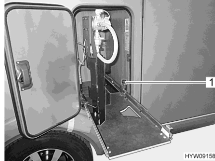
Bild 93 Gaskastenauszug in Wechselstellung
