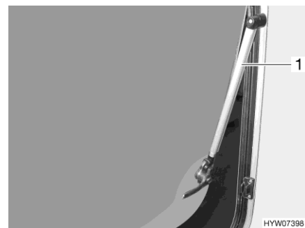
Bild 45 Ausstellfenster mit Automatik-Aussteller
