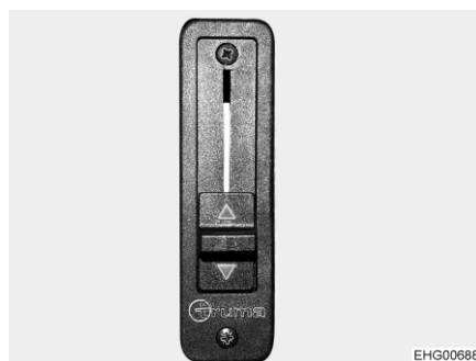
Afb. 115 Schuifregelaar voor verdeling van de hete lucht in het slaapdak
