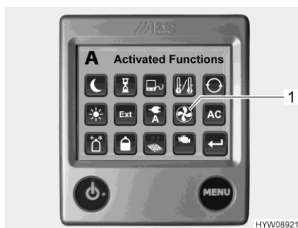
Fig. 167 Funzioni attivate (ventola aggiuntiva)
