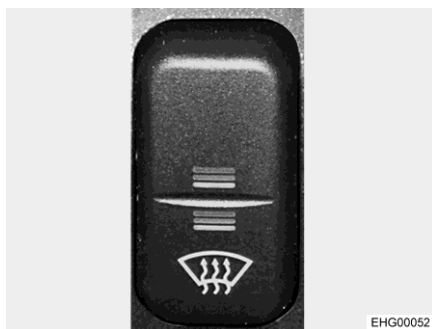
Fig. 9 Interruttore a bilico (riscaldamento del parabrezza)
