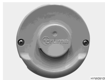
Fig. 174 Camino da parete (riscaldamento ad aria calda)
