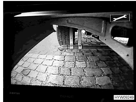
Bild 34 Visning av avloppstankskameran (exempel)
