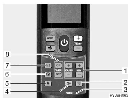
Bild 177 Fjärrstyrning med inställningsknappar (klimatanläggning)
