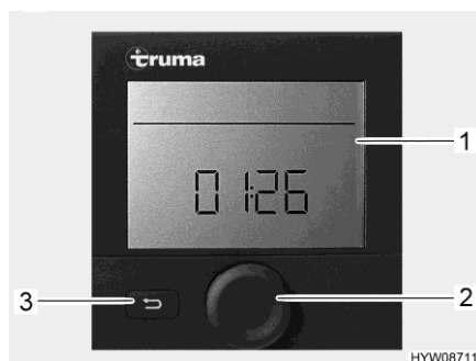
Bild 152 Kontrollenhet (varmluft-värmesystem och varmvattenberedare)
