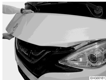
Bild 36 Korrekt grepp för att öppna motorhuv
