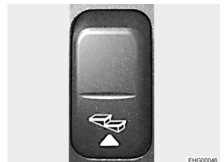
Afb. 8 Wipschakelaar voor opstap (schakelaarlijst)
