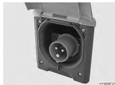
Bild 67 230-V-Anschluss am Fahrzeug (CEE-Steckdose)
