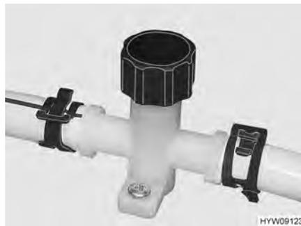
Bild 103 Ablasshahn (Wasserleitung)
