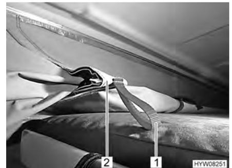
Bild 38 Einzugsvorrichtung (Aufstelldach)
