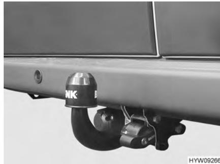
Bild 2 Anhängerkupplung (abnehmbar)
