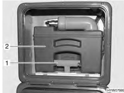
Bild 114 Fäkalientank (im Fahrzeug)
