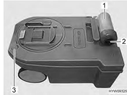
Bild 115 Fäkalientank (Alternative)
