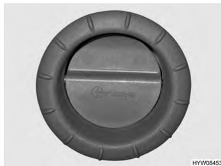
Bild 74 Luftaustrittsdüse (Warmluft-Heizung)
