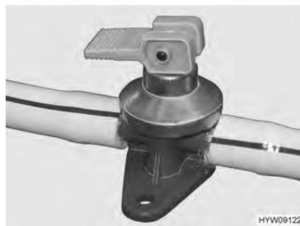
Bild 97 Ablasshahn (Boiler Truma)
