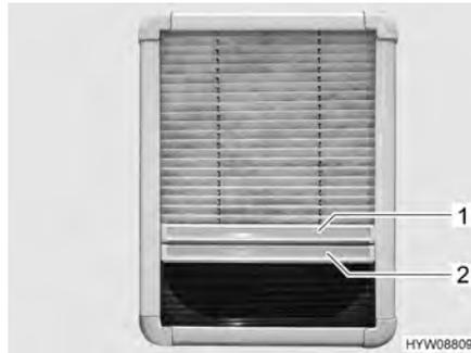
Bild 19 faltverdunklung und Insektenschutz
