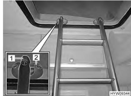
Bild 34 Aufstiegsleiter (eingehängt)
