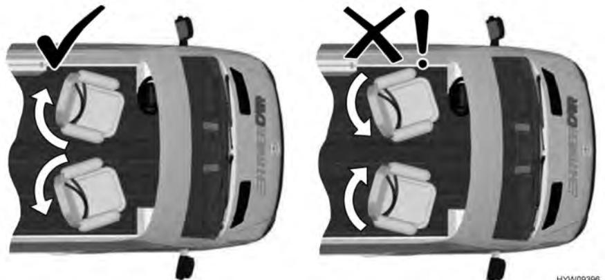
Fig. 41 Observar el sentido de rotación de asiento del conductor/acompañante
