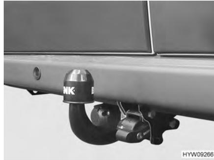
Fig. 2 Acoplamiento de remolque (desmontable)
