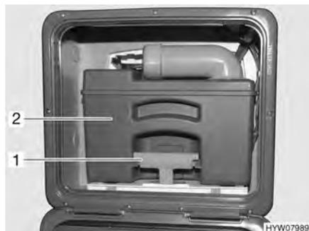
Fig. 114 Depósito de aguas fecales (en el vehículo) (alternativa)
