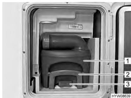
Fig. 112 Depósito de aguas fecales (en el vehículo)
