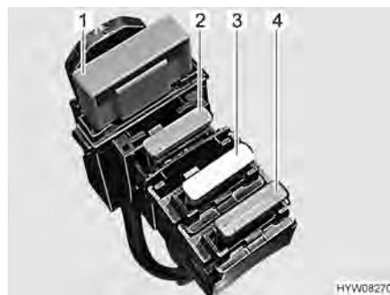
Fig. 69 Fusibles (batería del habitáculo)
