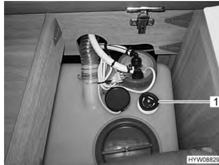
Fig. 99 Handle (water drain)
