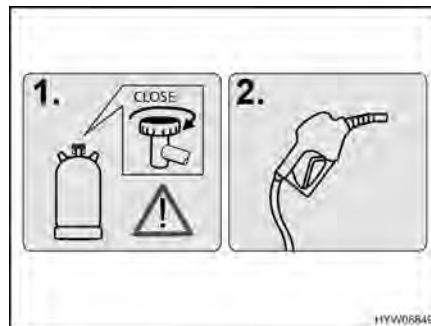
Fig. 10 Indication de sécurité (bec de remplissage du carburant)
