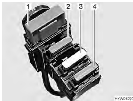
Fig. 69 Fusibles (batterie de cellule)
