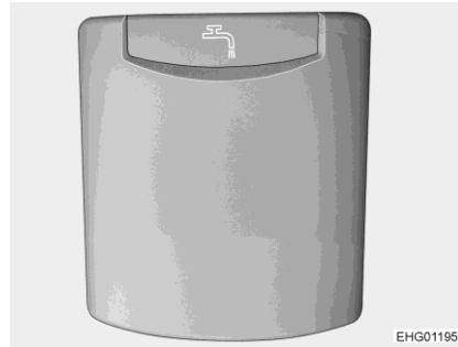
Kuva 124 Juomavesisäiliön täyttöaukon kansi
