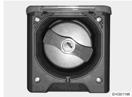
Kuva 125 Juomavesisäiliön täyttöaukon korkki
