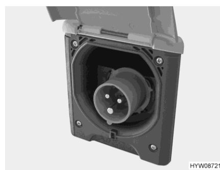
Bild 71 230 V-anslutning på fordonet (CEE-uttag)
