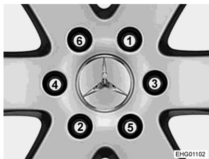
Fig. 118 Serrer en croix les écrous ou les boulons de roue
