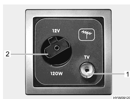
Fig. 51 Prises de courant (antenne DVB-T)
