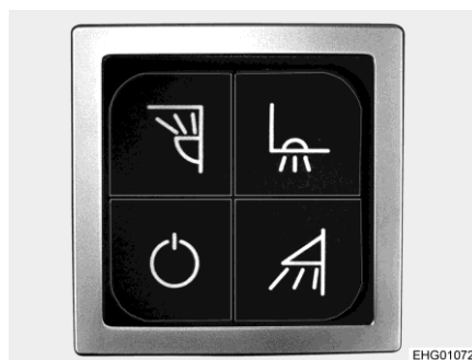
Fig. 52 Commutateur multiple d'éclairage (exemple)
