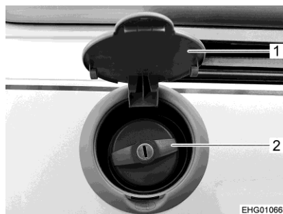
Fig. 99 Bec de remplissage d'eau potable
