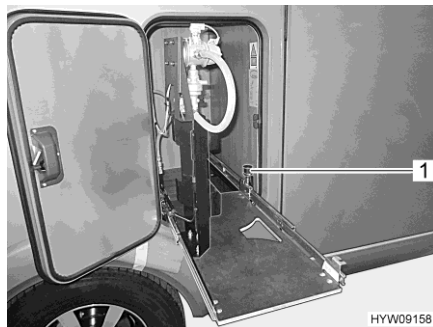
Kuva 119 Kaasupullokotelon alusta vaihtoasennossa
