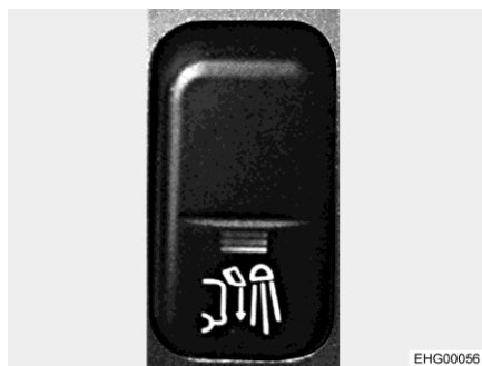
Kuva 42 Vipukytin (taka-alueen valaistus)
