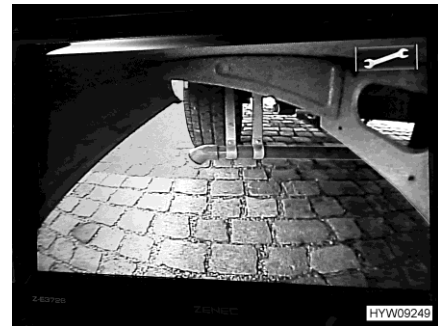
Bild 34 Anzeige der Abwassertankkamera (Beispiel)
