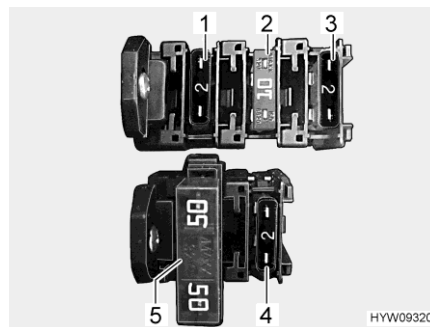
Bilde 79 Sikringer (boenhets-batteri)
