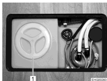
Bilde 116 Rengjøringsåpning (vanntank)
