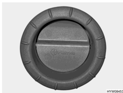
Rys. 101 Dysza wylotowa powietrza (ogrzewanie powietrza)
