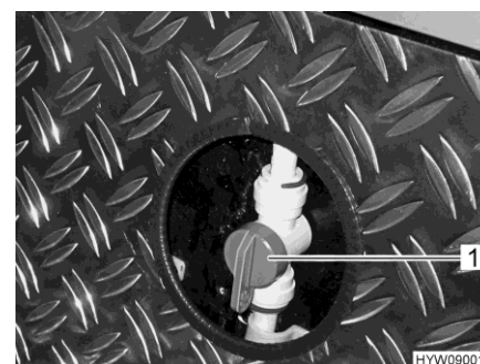
Afb. 134 Voorloopventiel (verwarming garage achter)
