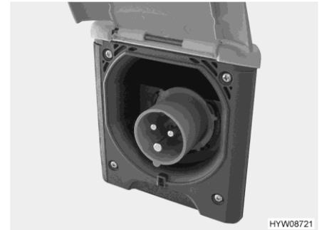
Fig. 107 Collegamento a 230 V al veicolo (presa CEE)
