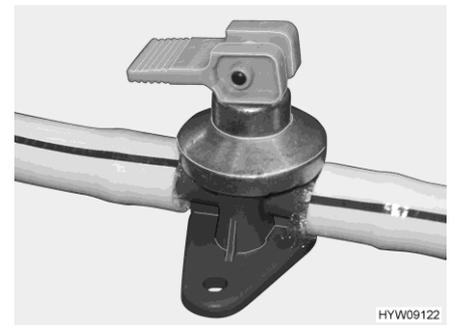
Fig. 126 Rubinetto di scarico (boiler Alde)
