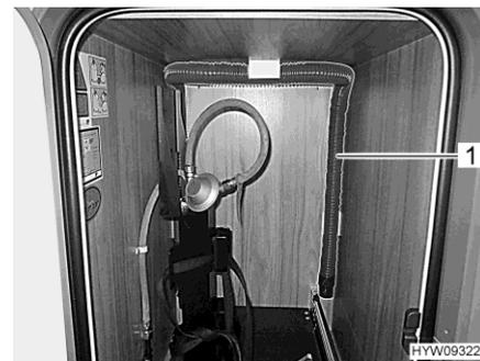
Fig. 160 Tubo di gomma per lo scarico (base estraibile del vano portabombole)
