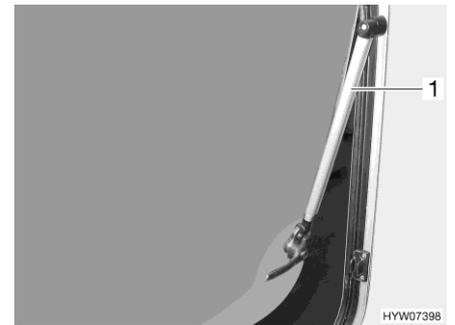
Fig. 39 Finestra apribile con deflettore automatico
