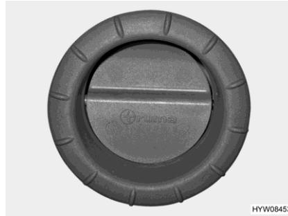
Fig. 116 Bocchetta di uscita dell'aria (riscaldamento ad aria calda)
