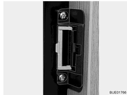
Fig. 152 Dispositivo de cierre (posición de ventilación)
