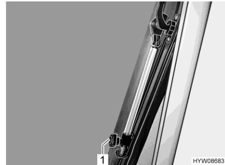
Fig. 42 Soporte rotatorio (ventana de techo abatible)
