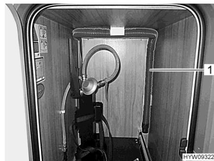
Fig. 160 Manguera de aguas residuales (dispositivo de extracción de caja para bombonas de gas)
