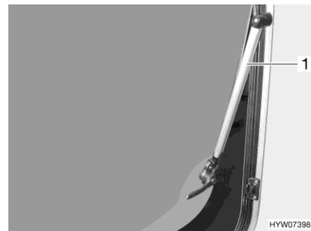
Fig. 39 Ventana abatible con soporte automático
