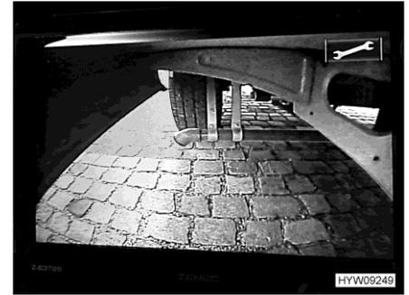
Fig. 24 Visualización de la cámara del depósito de aguas residuales (ejemplo)
