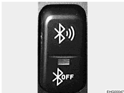
Fig. 96 Pulsador basculante (conexión Bluetooth)
