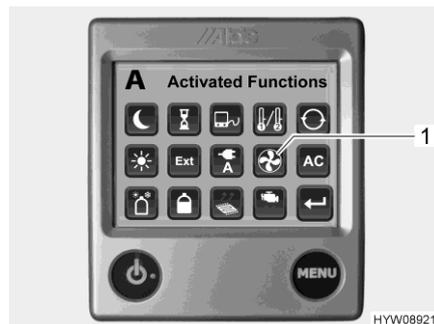
Fig. 129 Funciones activadas (ventilador adicional)
