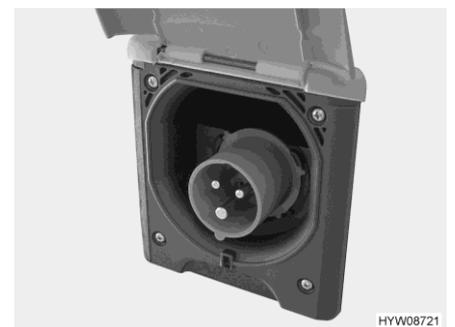
Bild 105 230-V-Anschluss am Fahrzeug (CEE-Steckdose)
