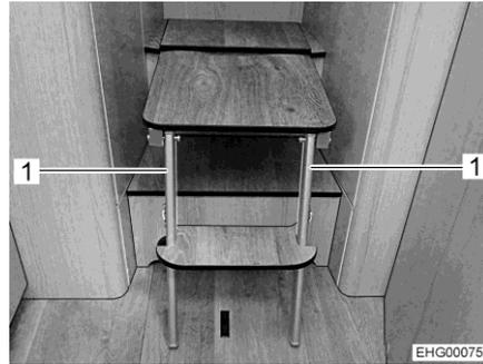
Bild 84 Aufstiegsleiter (ausgeklappt)
