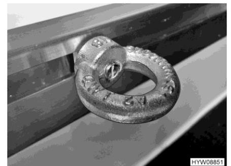
Bild 7 Verzurröse (geklemmt)
