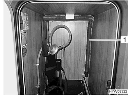
Bild 141 Abwasserschlauch (Gaskastenauszug)
