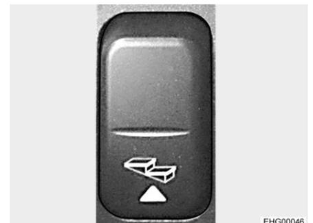
Bild 11 Wippschalter für Eintrittstufe (Armaturenbrett)
