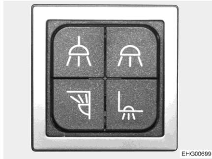
Bild 74 Mehrfach-Lichtschalter
