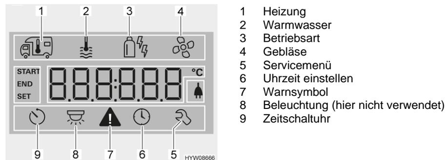
Bild 119 Display (Bedienteil)
