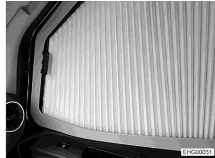
Bild 49 faltverdunklung (Beifahrerfenster)
