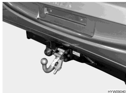
Bild 9 Anhängerkupplung (abnehmbar)
