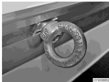
Bild 6 Verzurröse (verschiebbar)
