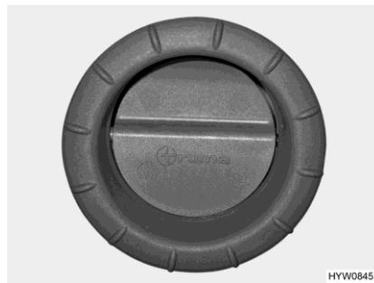
Bild 116 Luftaustrittsdüse (Warmluft-Heizung)
