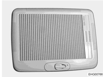
Bild 52 Dachhaube (Lamellenplissee geschlossen)
